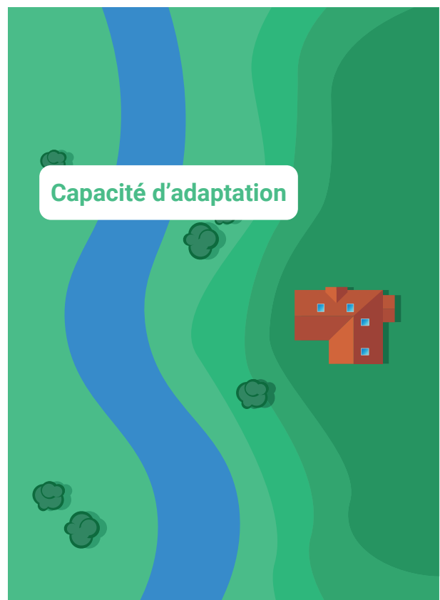
Figure 4 : La maison n'est pas plus exposée aux inondations parce qu'elle est éloignée de la rive et construite sur un terrain plus élevé
